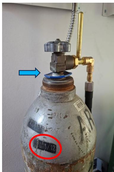
איור 3: גליל גז ארגון- זיהוי תוקף הבדיקה התקופתית לפי הטבעת שעל הגליל.
